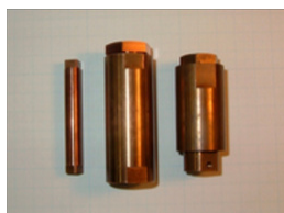
図2：試料に圧力かける装置。上下のネジで圧力を閉じ込めて保持できる。測定手法によって使い分ける。長さは6cm、外径は1~2.5cm。中央の装置で3GPaの圧力を発生することができる。
