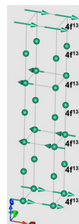
図8： T=0.59\text{K} におけるYbPdの磁気構造。ここではPdは省略されている。矢印は 4f^{13} の磁気モーメントを示しており、 4f^{13.4} は磁気モーメントを持たない。磁気モーメントはa軸方向を向き、波数ベクトル k = [0.080 \ 0 \ 0.32] を持つ。磁気モーメントの大きさがサイン波的に変化するの熱的揺らぎのためと考えられる。非常に複雑な構造であるが、磁気モーメントを持つ 4f^{13} は二次元正方格子を組んでいることから磁気的不安定性の強い状態と考えられている。 T=0.5\text{K} に機構不明な相転移が報告されているが、熱的揺らぎが抑えられることによる別の磁気構造(よりシンプルな磁気構造)が予測されている。
