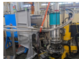
図4：日本原子力開発機構のJRR-3内のT1-1ビームライン。原子炉から出てくる中性子を利用してYbの磁気モーメントの配列の仕方を調べている。冷凍機(右側の水色の装置)で試料を0.3Kまで冷やして実験をしている。
