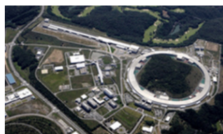
図3：大型放射光施設SPring-8。蓄積リング(写真右、1周1400m)内で電子を光速に近い速度で運動させ、発生するX線を使って物質の性質を調べることができる。我々は物質の構造や価数を調べる測定を行ってきた。
