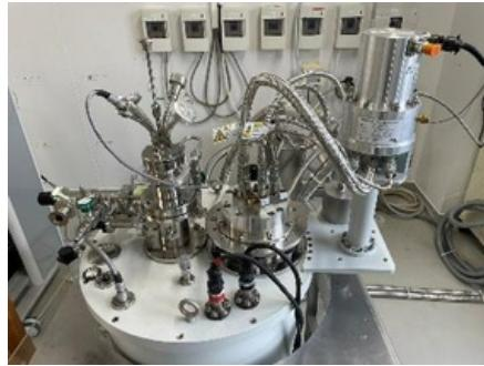
図1：無冷媒冷凍機（室温300 K - 2 K）
