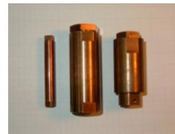
図2：試料に圧力をかける装置。上下のねじで圧力を閉じ込めて保持できる。測定手法によって使い分ける。長さは6cm、外径は1~2.5cm。中央の装置で3GPaの圧力を発生することができる。
