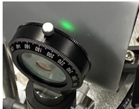
図5：非線形光学結晶を透過した光が、目に見えない近赤外光から緑色の光になる第2高調波発生。
