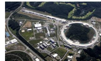
図3：大型放射光施設SPring-8。蓄積リング(写真右、1周1400m)内で電子を光速に近い速度で運動させ、発生するX線を使って物質の性質を調べることができる。我々は物質の構造や値数を調べる測定を行ってきた。
