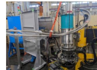
図4：日本原子力開発機構のJRR-3内のT1-1ビームライン。原子炉から出でてくる中性子を利用してYbの磁気モーメントの配列の仕方を調べている。冷凍機(右側の水色の装置)で試料を0.3Kまで冷やして実験をしている。
